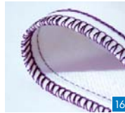
4-Faden-Sicherheitsnaht, schmal Zum Zusammennähen mit verstärktem Stich und gleichzeitigem Versäubern.
