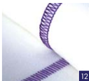
3-Faden-Flatlock, breit Zum Zusammennähen elastischer Stoffe mit Dekoeffekten, entweder mit der Flatlock- oder der Leiterstich-Seite.
