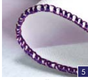
2-Faden-Rollsaum Kantenversäuberung von feinen Stoffen. Optimal für Seidenschals, Kissenrüschen oder Servietten.
