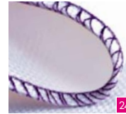
3-Faden-Overlock, umgelegt, schmal Perfekt für Stoffkanten an Rücken oder gekräuselte Kanten an feinen Stoffen.
