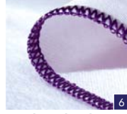
2-Faden-Schmal-kantenstich Kantenversäuberung für dünne und mittelschwere unelastische Stoffe sowie dünne Strickstoffe.
