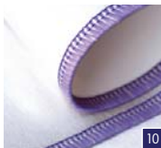
3-Faden-Overlock-Stretch Zum Nähen besonders elastischer leichter und mittelschwerer Stoffe. (Zusätzliche Elastizität erzielen Sie mit einem elastischen Faden in den Greifern.)
