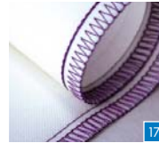
4-Faden-Sicherheitsnaht, breit Zum Zusammenfügen mit verstärktem Stich und gleichzeitigen Versäubern.
