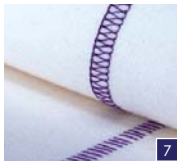
2-Faden-Flatlock, breit Näht elastische Stoffe zusammen und erzeugt gleichzeitig einen Dekoeffekt. Versäubert Kanten an normal schweren Stoffen.
